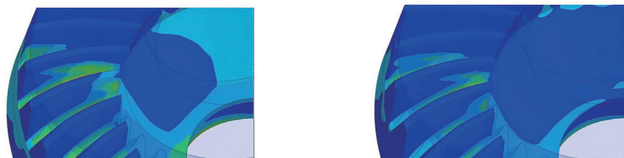
图6 从动锥齿轮在稳定阶段的应力云图
