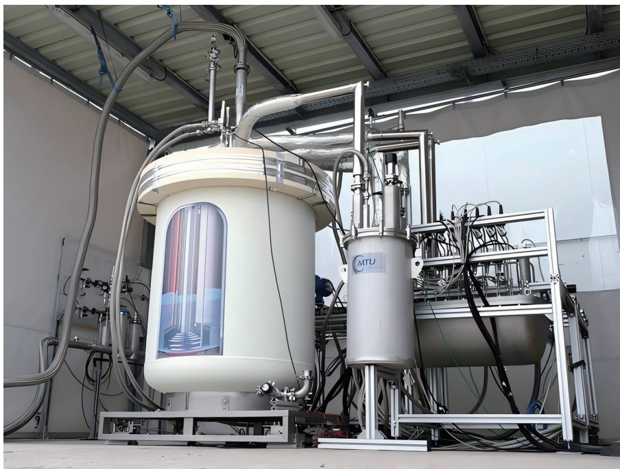
MTU公司完成飞行燃料电池液氢燃料系统测试
