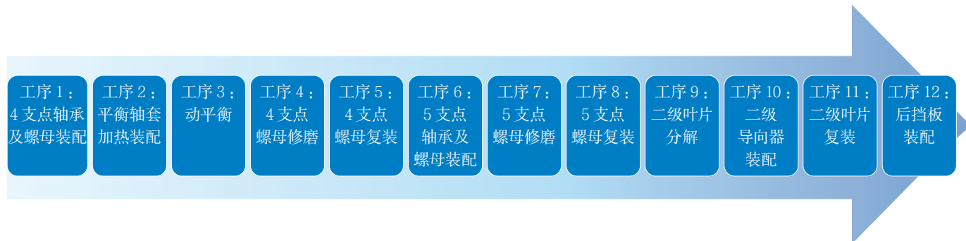
图2 低压涡轮转子现行装配工艺路线
