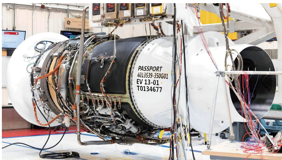
GE 航空航天公司在 Passport 发动机中嵌入电动发电机
