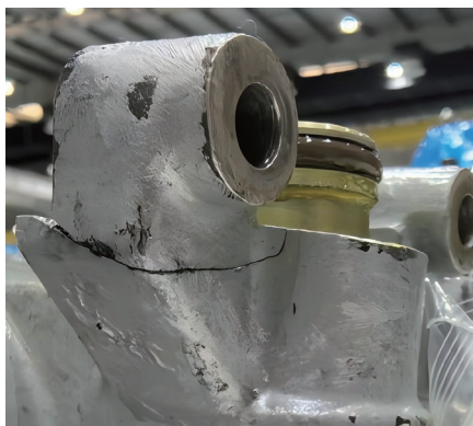
图1 滑油滤壳体断裂情况
