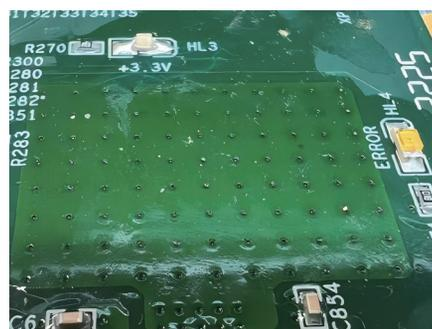
图2 现有三防漆在长期温循试验后开裂
